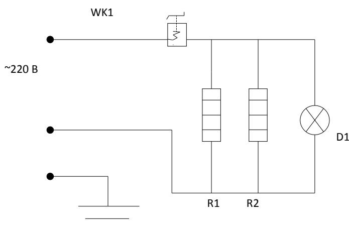
**R1, R2 - Нагревательная трубка D- Индикатор нагрева WK1 - Термостат**
